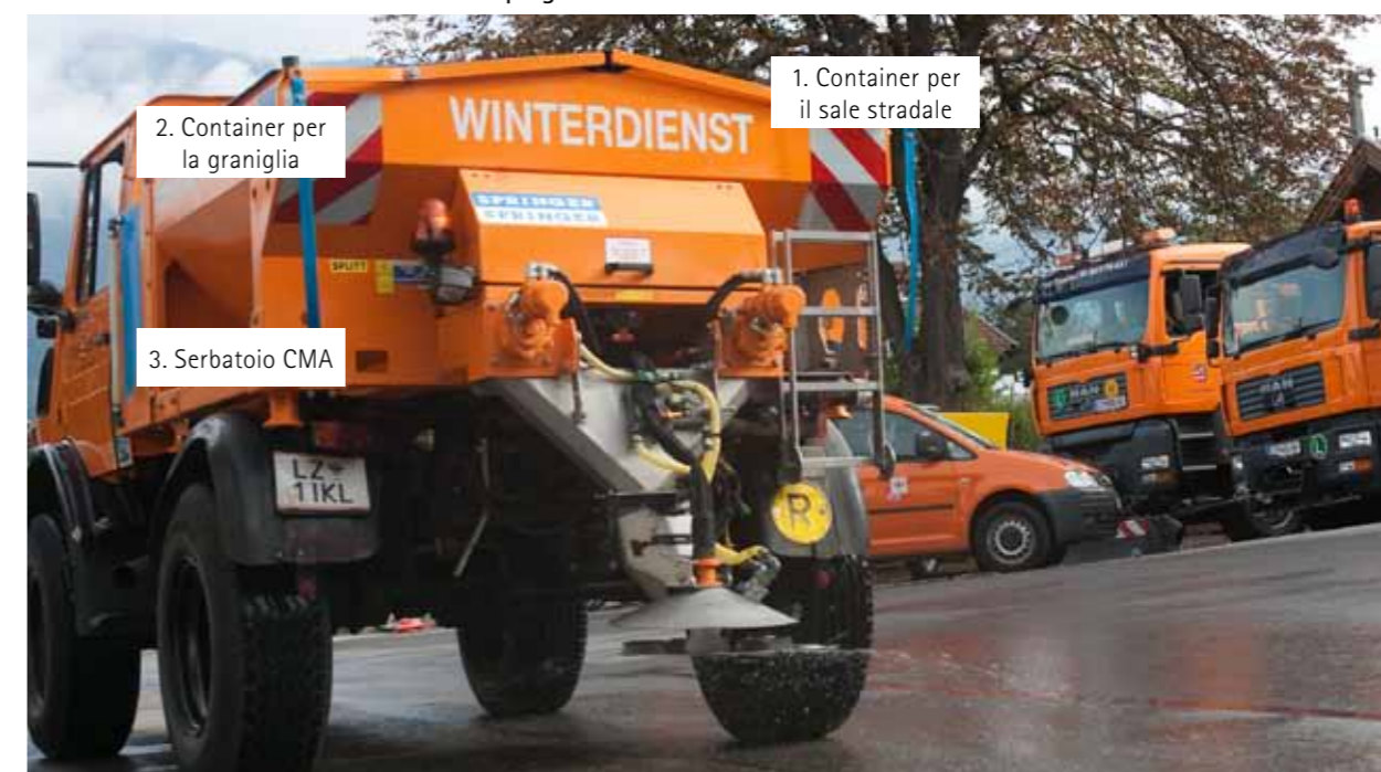
Fig. 15 Macchina spargitrice a Lienz
