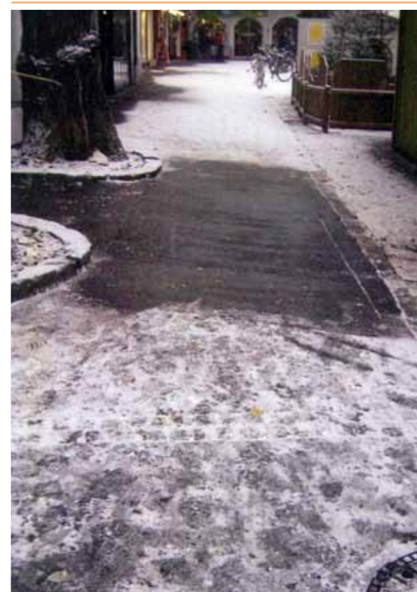
Fig. 5 Applicazione a Lienz, zona pedonale: un effetto di scioglimento del ghiaccio è chiaramente rilevabile fino ad uno strato di ca. 3 cm di neve fresca.
