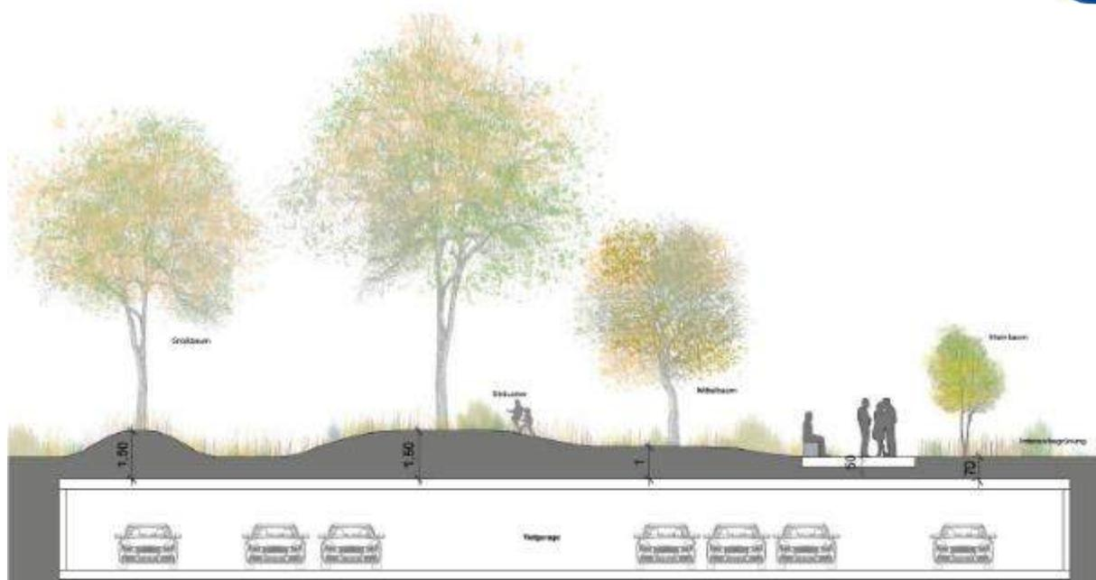
Abbildung 21 Konzeptschnitt Substrataufbau über Tiefgaragen. © WLA
