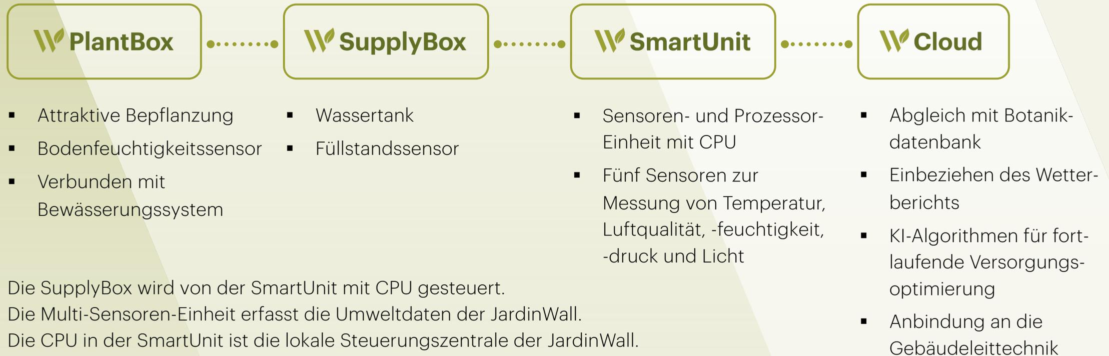
Die SupplyBox wird von der SmartUnit mit CPU gesteuert.
