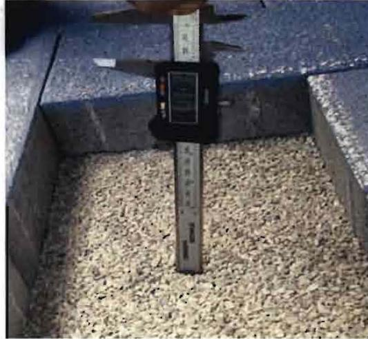
Dabei wurde festgestellt, dass die unter den ca. 8 cm starken Pflastersteinen befindliche Splittbettung (Korngruppe 2 – 4 mm), welche an unterschiedlichen Stellen nachgemessen wurde, in einer Minimalhöhe von ca. 2,3 cm und bis zu einer Maximalhöhe von ca. 4,0 cm auf dem bestehenden Asphaltbelag aufgebracht wurde.
