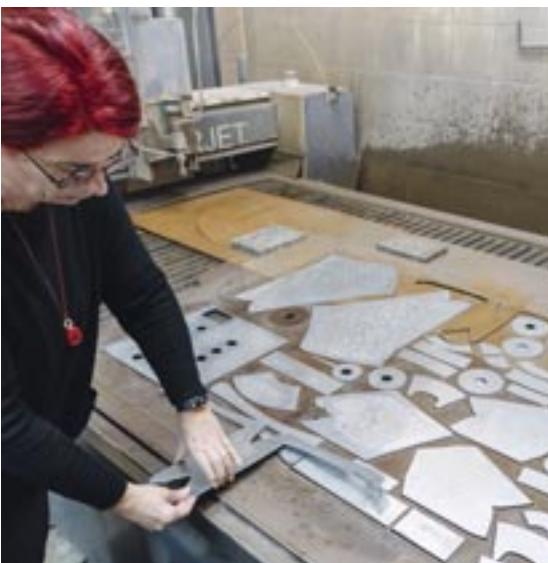
Mit dem Wasserstrahlschneider kann präzise geschnitten werden. Fotos: Wiedergut
