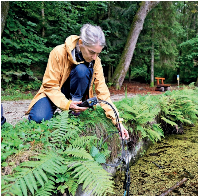
Umweltmesstechnikerin Saskia Gschwind beim Erheben der Wasserparameter (Sauerstoff, pH-Wert und Leitfähigkeit) am Kreuzbergleich. Foto: SK/Bauer
