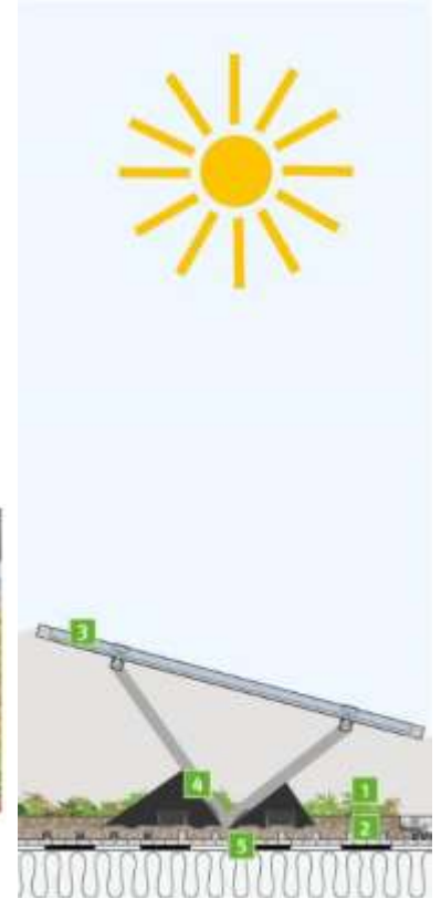
Abb. 130: PV-Außtachtanlage mit extensiver Dachbegrünung (Foto: ZinCo GmbH)
