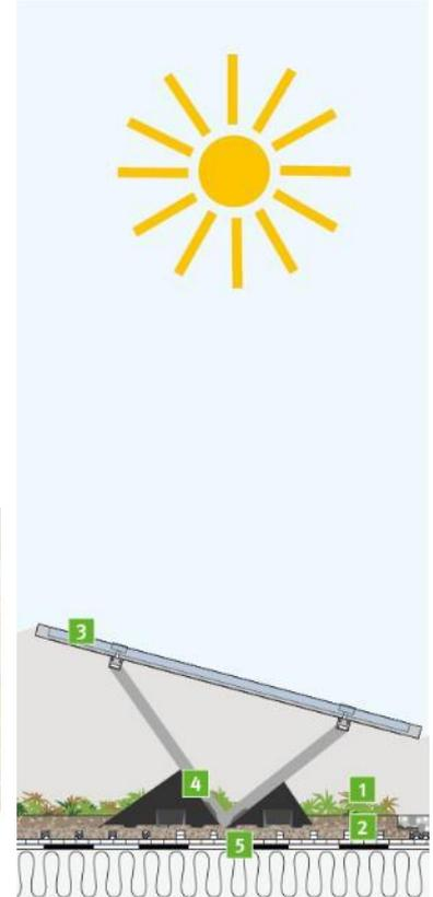
Abb. 130: PV-Aufdachanlage mit extensiver Dachbegrünung (Foto: ZinCo GmbH)
