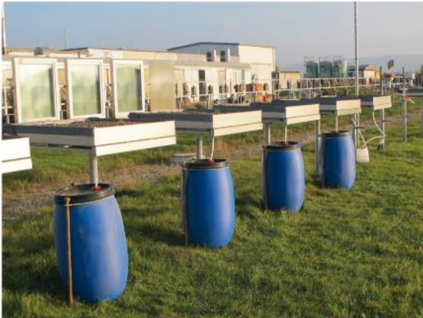
Bild 6: Tonnen zur Ermittlung großer Ablaufwasservolumina. Rechts im Bild: Wetterstation zur Aufzeichnung der meteorologischen Daten.
