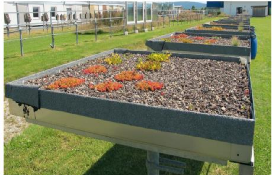
Bild 29: Probekörper mit Substrat und Bepflanzung im Juli 2016.
