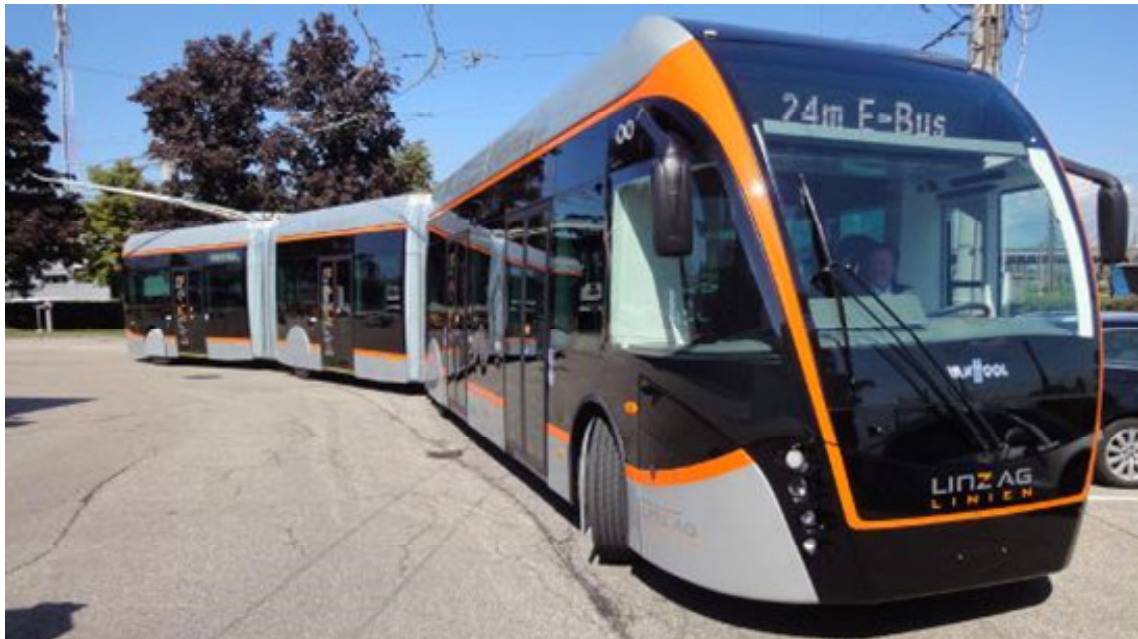
Abbildung 6-7: Beispiel E-Bus mit In-Motion-Charging Technologie
